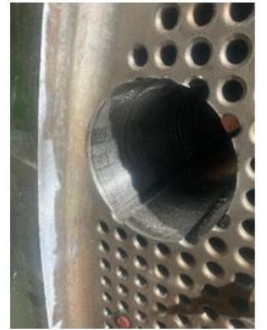
Trou dans la Plaque à Tubes suite à carottage
